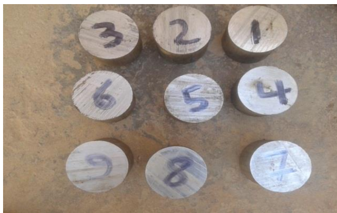
شكل(6) يوضح ترقيم العينات الجاهزة لعمل الثقوب
