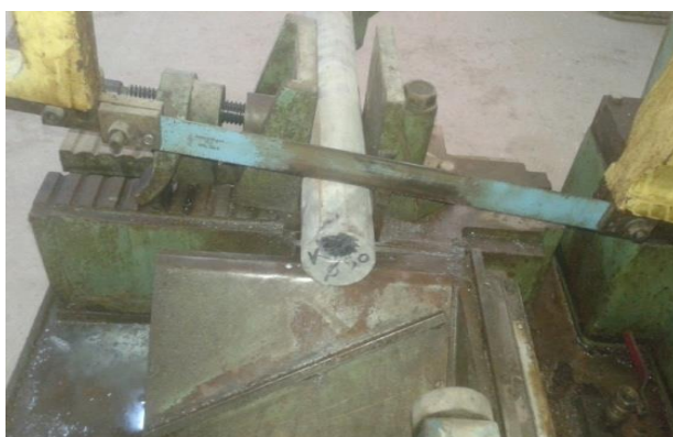
شكل (1.5) يوضح بدء عملية قص العينات .
