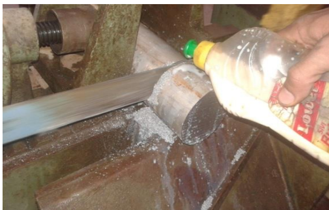
شكل (2.5) يوضح كيفية قص العينة باستخدام سائل التبريد .
