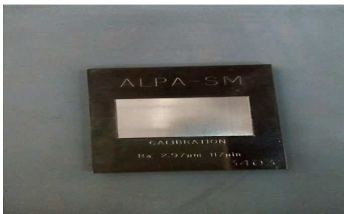
(8) شكل قطعة المعايرة للجهاز الخشونة
